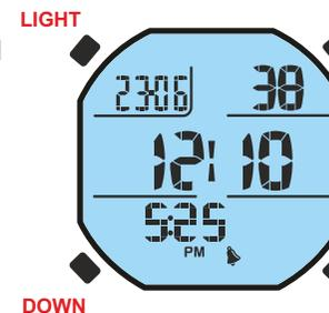
**MODE Taste** : Durch Drücken der Taste für kurze Zeit wird der Zugang zu den verschiedenen Menüs ermöglicht. Bei anhaltendem Drücken der Taste, egal in welcher Position, dient sie zum Verlassen des jeweiligen Menüs und zum Übergang auf die Uhrfunktion. In der Funktion UHR gelangt man durch anhaltendes Drücken der Taste (4 Sekunden) zum Tauchcomputer. In der SET TIME Funktion bestätigt kurzes Drücken in einigen Fällen die eingegebene Einstellung.
