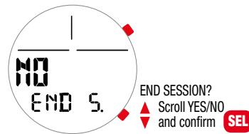
**ПРИМЕЧАНИЕ:** После часа пребывания на поверхности, сессия закроется автоматически.
