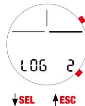
Память NEPTO/KING позволяет записывать до 32 профильных часов с частотой кадров 2 секунды.
