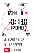
Para activar o detener el cronómetro, pulse los botones UP ▲ / DOWN ▼; Puede registrar tiempos parciales pulsando el botón DOWN ▼ mientras el cronómetro está en marcha; en este caso, en la esquina superior izquierda la hora será sustituida por la palabra LAP y se podrán leer los tiempos intermedios en la línea central de la pantalla.
