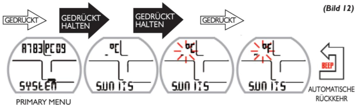
**MODUS SYSTEM : RESET GERÄT**
