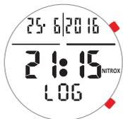
最初の線は、ダイビングの日、月と年を示します。NITROX フリーゲージモデルのダイビングでは関連アイコンが表示されます。ボタンを押すことにより、**SEL** ダイビングに関するデータを見ることができます。
