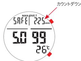
安全な停止は、SAFEアイコンで画面に表示されます。この状態では、画面は分と秒のカウントダウンで、停止時間を明確に示します。それが強制でない間、例えば最大上昇率が繰り返し超過するとき、安全な停止が強く推奨されます。CRESSIは、安全に関わる問題回避のため、定期的な活動停止を勧めます。
