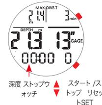
押し続けてください。最後のラインは下記の数字で示すように、ストップウォッチ・データを提供します。
